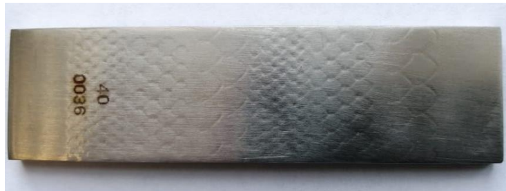
Образец титанового сплава ВТ6 обработанного при различных режимах
