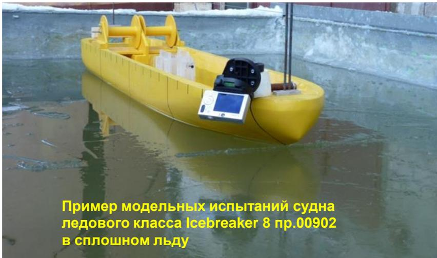
Пример модельных испытаний судна ледового класса Icebreaker 8 пр.00902 в сплошном льду
