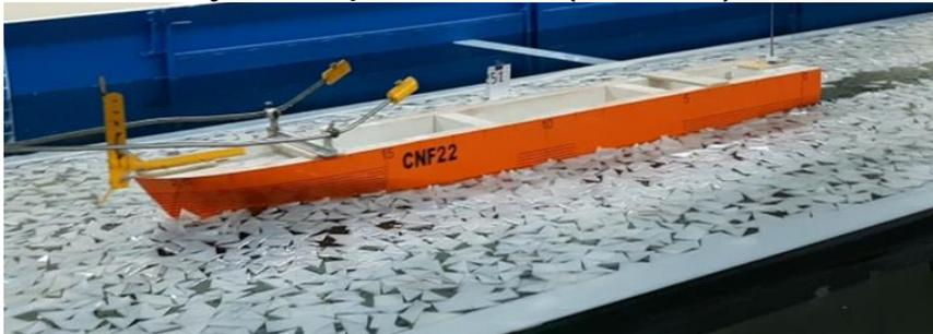
Фрагмент движения модели судна пр. CNF22 носом во льду сплоченностью 8 бал. и  $v=12$  уз.
