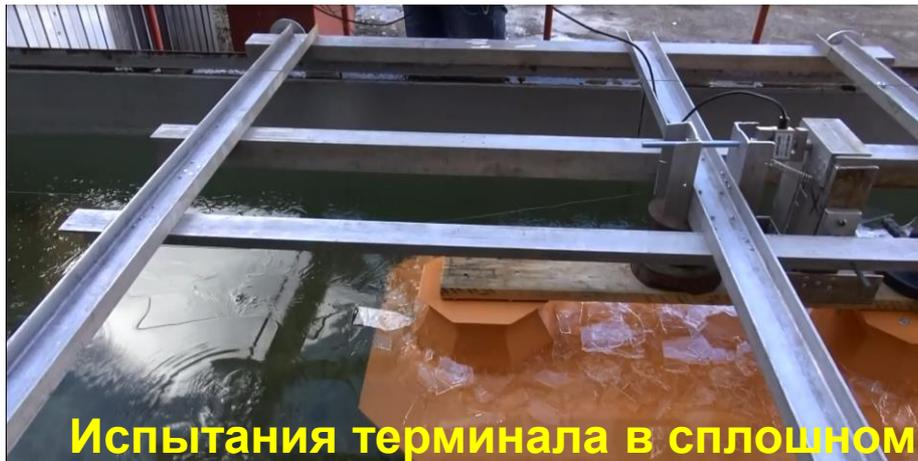
Испытания терминала в сплошном льду
